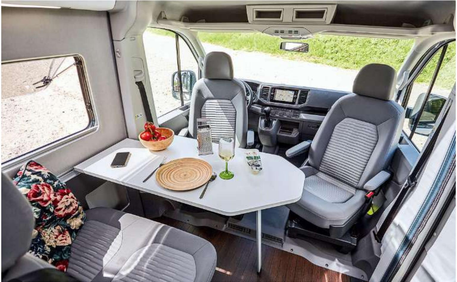
I sedili anteriori sono stati progettati per essere facilmente configurabili, ruotando di 180 gradi, se devi guidare o semplicemente socializzare.
