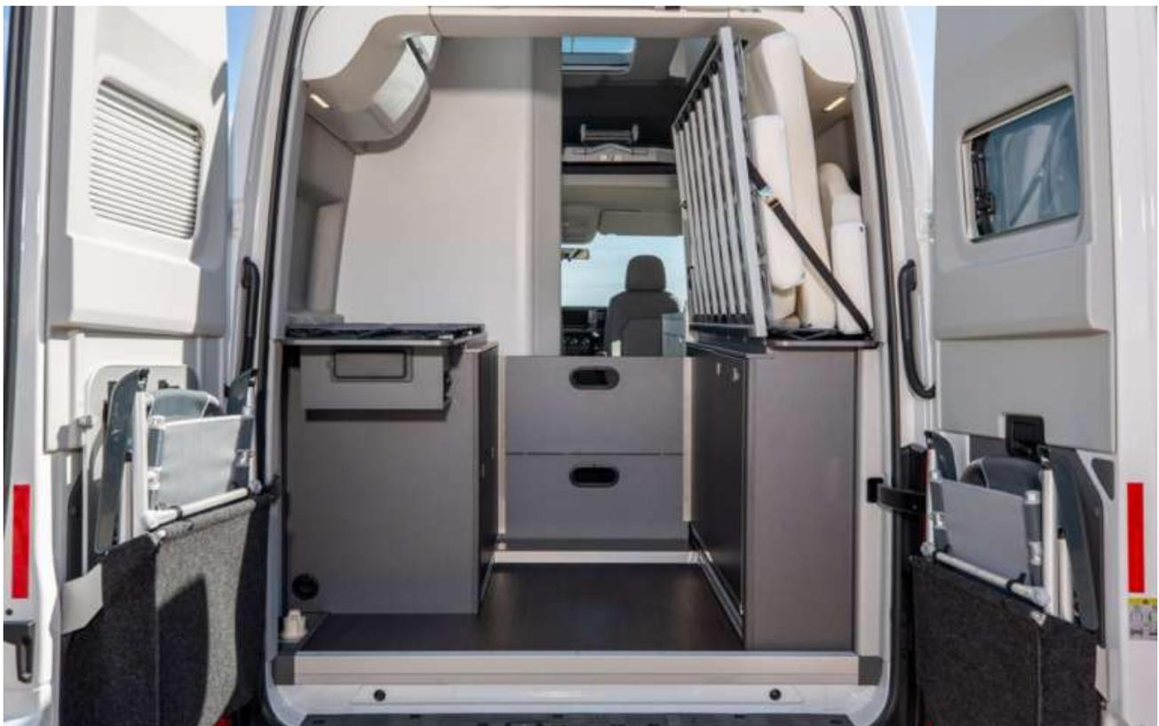
Due ampie porte apribili a 180 gradi permettono l'accesso all'area di carico, dotato di serie di tavolo da esterno e due sedie che trovano posto all'interno delle porte posteriori.
